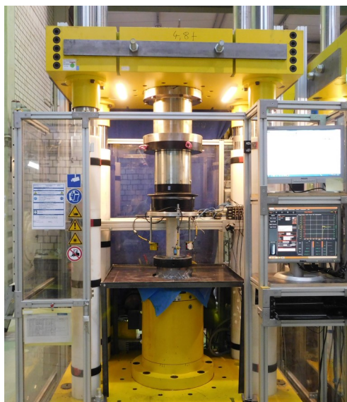
Abbildung 1: Viersäulenprüfstände für die statische und dynamische Prüfung von Betonproben
