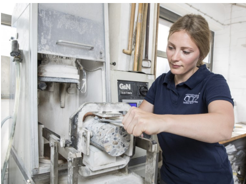
Abbildung 3: Schleifen von Betonprobekörpern
