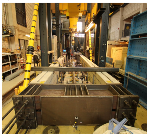
Abbildung 2: Spannrahmen für horizontale Prüflasten von bis zu 5 MN
